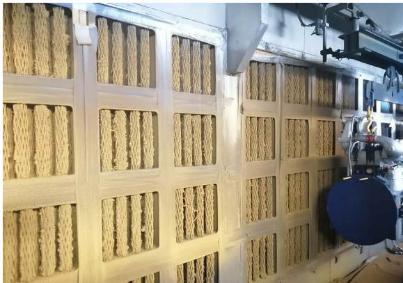
開展幹式噴漆房改造項目，提升噴漆廢氣的吸附去除效率，降低廢氣排放濃度
