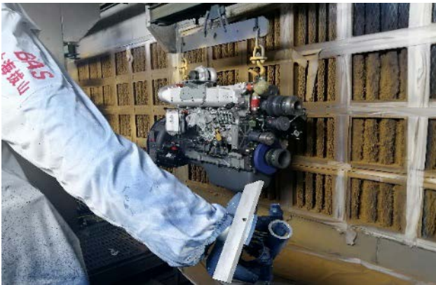
開展幹式噴漆房改造項目，提升噴漆廢氣的吸附去除效率，降低廢氣排放濃度
