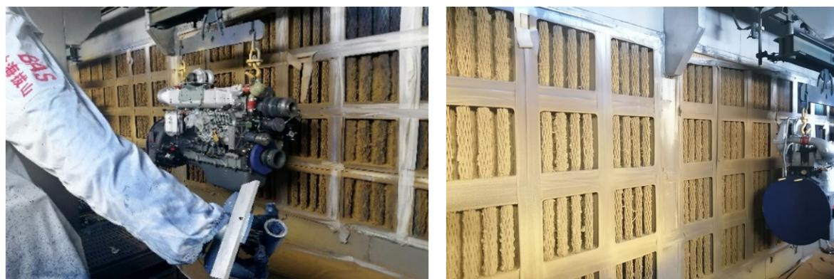
开展干式喷漆房改造项目，提升喷漆废气的吸附去除效率，降低废气排放浓度
